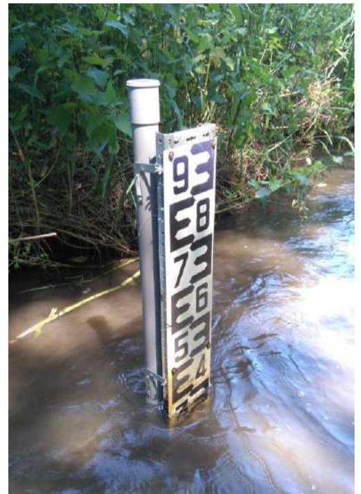
*Figure 3: Le suivi des échelles limnimétriques permet d'avoir une vision très précise des effets des travaux sur l'hydraulique du marais (Photo PNR LAT)*
