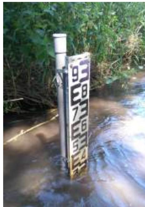
*Figure 8: Le suivi des échelles limnimétriques permet d'avoir une vision très précise des effets des travaux sur l'hydraulique du marais (Photo PNR LAT)*
