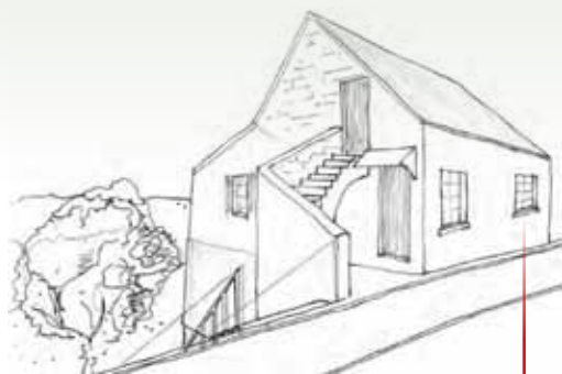
Habitation de marinier à double accès : depuis la levée en partie haute, sur la plaine alluviale en partie basse.
