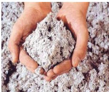
Le plafond du 1<sup>er</sup> étage est isolé par 40 cm de ouate de cellulose en vrac ( $R=7,8 \text{ m}^2.K/W$ ). La ouate de cellulose est issue du recyclage du papier. Elle est souvent utilisée pour l'isolation des combles car elle concilie un bon confort thermique d'hiver et d'été avec un prix abordable.
